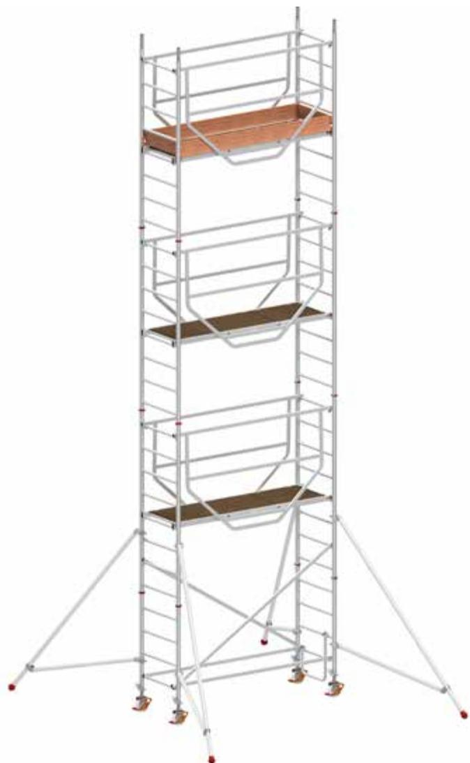
**Sécurité maximale, confort convaincant :** Sécurité maximale à chaque étape de la construction grâce au garde-corps de sécurité SAFE-T, qui est déjà accroché par le bas. Stabilisateur télescopique avec fermeture à baïonnette à une hauteur de portée de 9,27 mètres pour compenser les irrégularités du sol. Plate-forme spacieuse, résistante aux intempéries et antidérapante. Avec quatre roulettes pivotantes réglables en hauteur.
